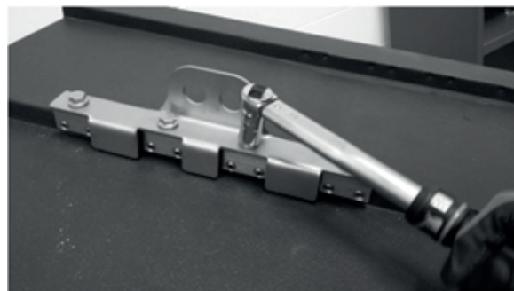
6 – SERRAGGIO BULLONI M10 (n°4 X 20 Nm)
